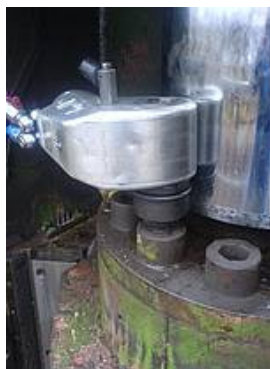
Inbus-Schrauben an Metso Lindemann Scheren / Pressen-Zylindern: nur ein Schraubgerät passt dank der niedrigen Gehäuseform hier rein - der TorcUP TU-11, dank der einzelnen, flexiblen Drehanschlüsse!
